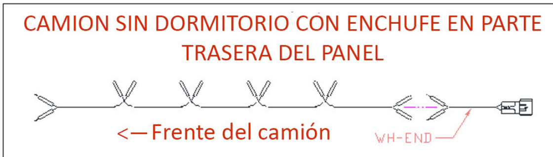
Figura 2: Alambrado para camiones sin dormitorio con enchufe en la parte trasera del panel
