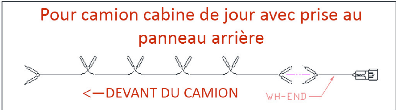
Figure 2 : Câblage pour cabines de jour avec prise à l'arrière du panneau
